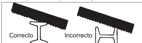
3. Coloque el apoyo de trabajo contra la pieza en la que se está trabajando y baje la següeta de la sierra en movimiento hacia el corte.
