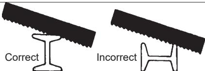
3. Placer le support de travail contre la pièce de travail et abaisser la lame de la scie en mouvement dans la coupe.
