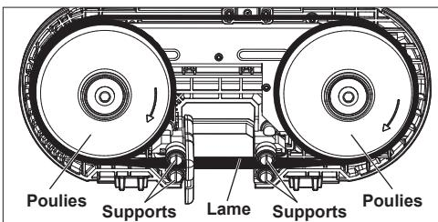
5. Pour installer une lame, appuyer dessus entre les supports, puis l'enrouler autour des poulies.
